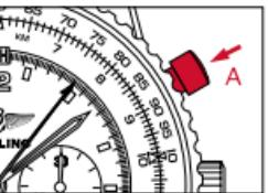
2. Parar a medição premindo novamente o pistão **A**. A medição é efetuada em horas [contador 1], minutos [contador 2], segundos e  $\frac{1}{4}$  de segundo [ponteiro 3].
