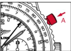
2. Fermare la misurazione premendo di nuovo il pulsante **A**. La misura si effettua in ore [totalizzatore **1**], in minuti [totalizzatore **2**], in secondi e in quarti di secondo [lancetta **3**].
