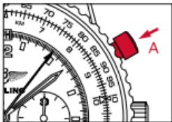
2. Zum Stoppen der Messung erneut Drücker **A** betätigen. Die Messung erfolgt in Stunden [Zähler **1**], Minuten [Zähler **2**], Sekunden und  $\frac{1}{4}$ -Sekunden [Zeiger **3**].
