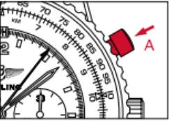
2. Arrêter la mesure en appuyant à nouveau sur le poussoir **A**. La mesure s'effectue en heures [compteur **1**], minutes [compteur **2**], en secondes et  $\frac{1}{4}$  de seconde [aiguille **3**].
