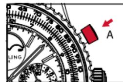
2. 時間計測を中断させるには、ボタン**A**をもう一度押します。時間計測を再開するには、再びボタン**A**を押します。このような操作で中断しながら、経過時間を測定することができます(積算計測)。
