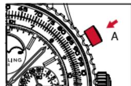
2. 再按一次A按鈕，即可結束計時。計時的結果以分鐘（計時盤1）、秒鐘與1/4秒（指針2）為單位顯示於錶面。
