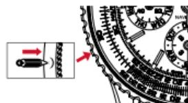
6. Volver a presionar la corona hasta la posición 1.
