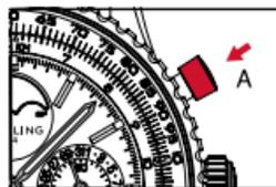
2. Unterbrechung der Zeitmessung durch Betätigen des Drückers **A**. Wiederaufnahme der Zeitmessung durch Betätigen des Drückers **A**. So lassen sich mehrere Zeitspannen messen und kumulieren.
