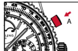
2. Arrêter la mesure en appuyant à nouveau sur le poussoir **A**. La mesure s'effectue en minutes [compteur 1], en secondes et 1/4 de seconde [aiguille 2].
