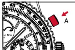
2. クロノグラフを停止させるには、もう一度ボタン**A**を押します。経過時間は、分(1)、1/4秒単位で測定できます(クロノグラフ秒針**2**)。
