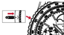
5. Tag: Drücken Sie Regler 2 bei 8 Uhr, bis der gewünschte Tag angezeigt wird.
